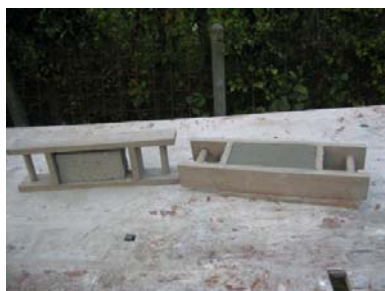
Twee mallen; je kunt goed zien dat de steen links in volume is afgenomen door het vochtverlies. Voor de foto is de gedroogde steen teruggelegd in de mal.
